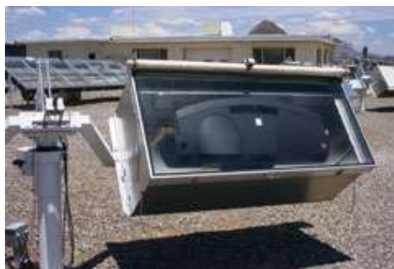
図2 アンダーグラス曝露試験の例（密閉型） 図3 IP/DP試験の例
