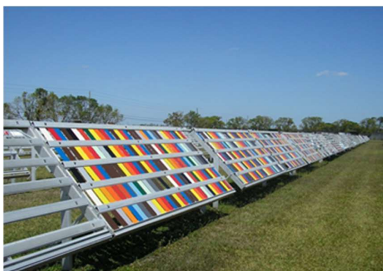
図1 マイアミでの45度曝露試験
