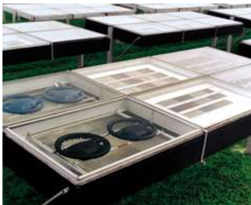
図2 アンダーグラス曝露試験の例（密閉型） 図3 IP/DP試験の例
